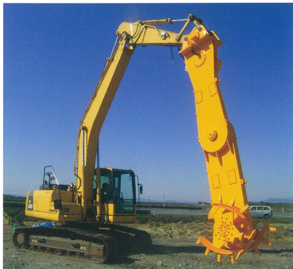
ブームランプレート装着でN値38の礫混じり砂層に対応
